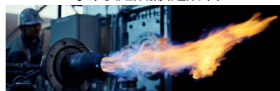
水素バーナ燃焼試験
